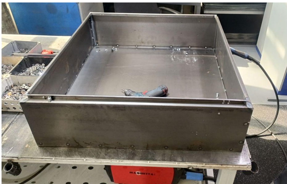
Рисунок 20- корпус после завершения сварки
