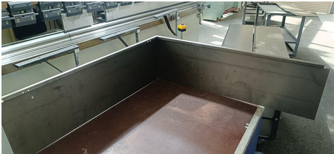
Рисунок 19- заготовка получаемая в процессе гибки прессом
